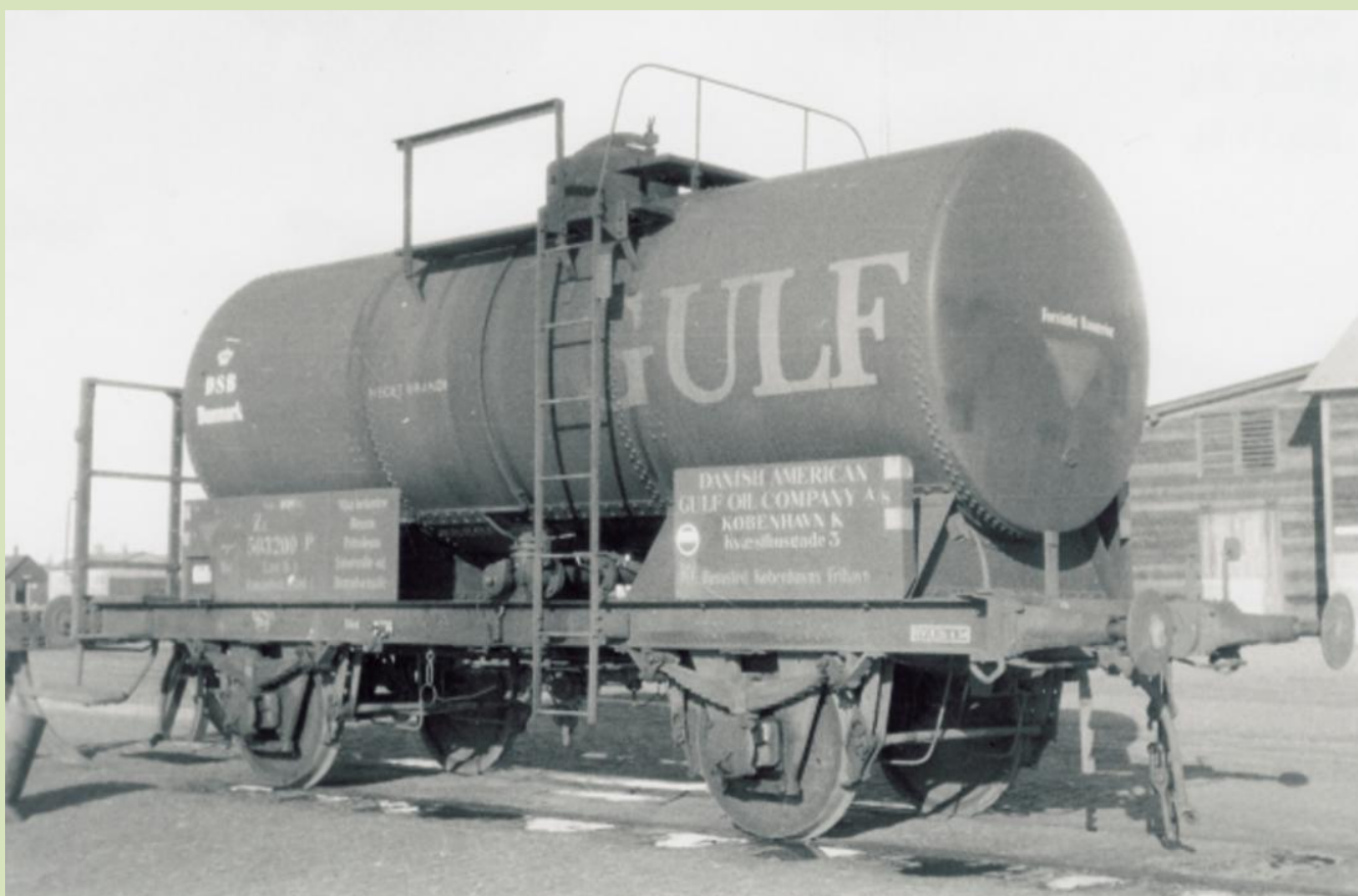
ZE 503 200. I Esbjerg, 1958. Vognen er bygget i 1922 og må høre til de første med tank samlet af 3 svøb. Tillig og Fleischmann modellerne har 1,5 mm. for stor akselafstand, læg lige mærke til det enorme gelænder på bremseplatformen. Foto.: P. E. Clausen. Arkiv DMJK.
