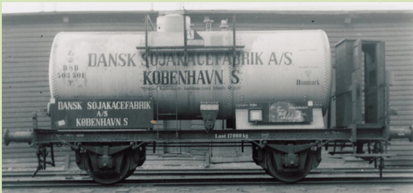
ZE 503 501 på Islands Brygge d. 11.02.1933. som det ses på dette og efterfølgende foto, er de tre første vogne leveret uden de karakteristiske skjolde på tankryggen.
