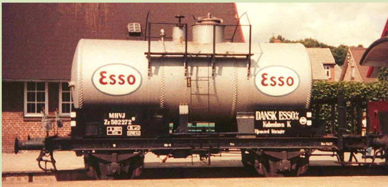
ZE 502 272. i Ryomgård 1982. Når man ved at der har været isolering på, kan man godt se at vognen er bygget med isolering. Foto.: jernbanen.dk
