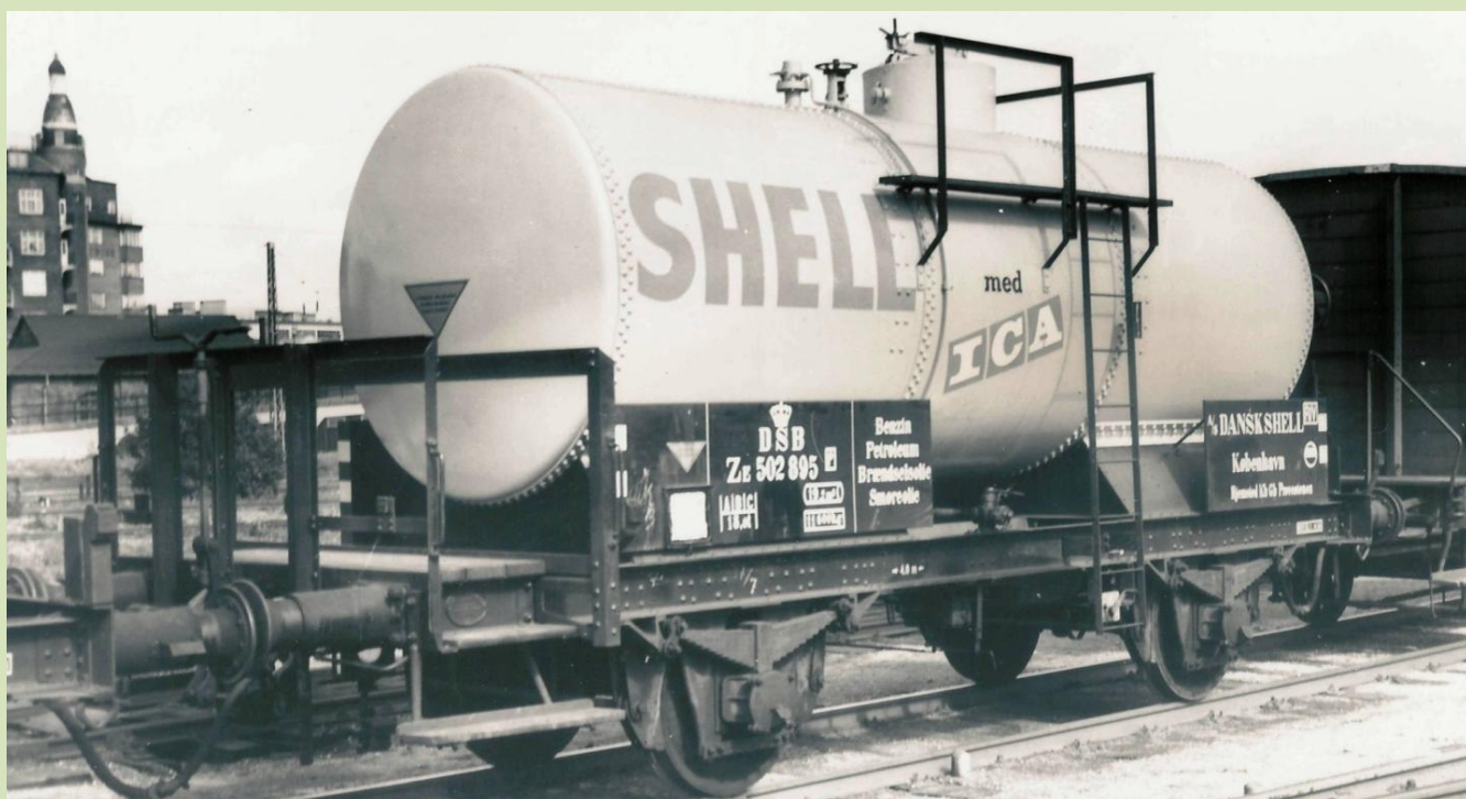
Svend Jørgensen fangede vognen i ca. 1955. Ud over at bremsehuset er væk, adressepladen skiftet og ny bemaling, er det ikke meget der er forandret. I baggrunden ses kloakpumpestationen ved Dybbølsbro på Kh.
