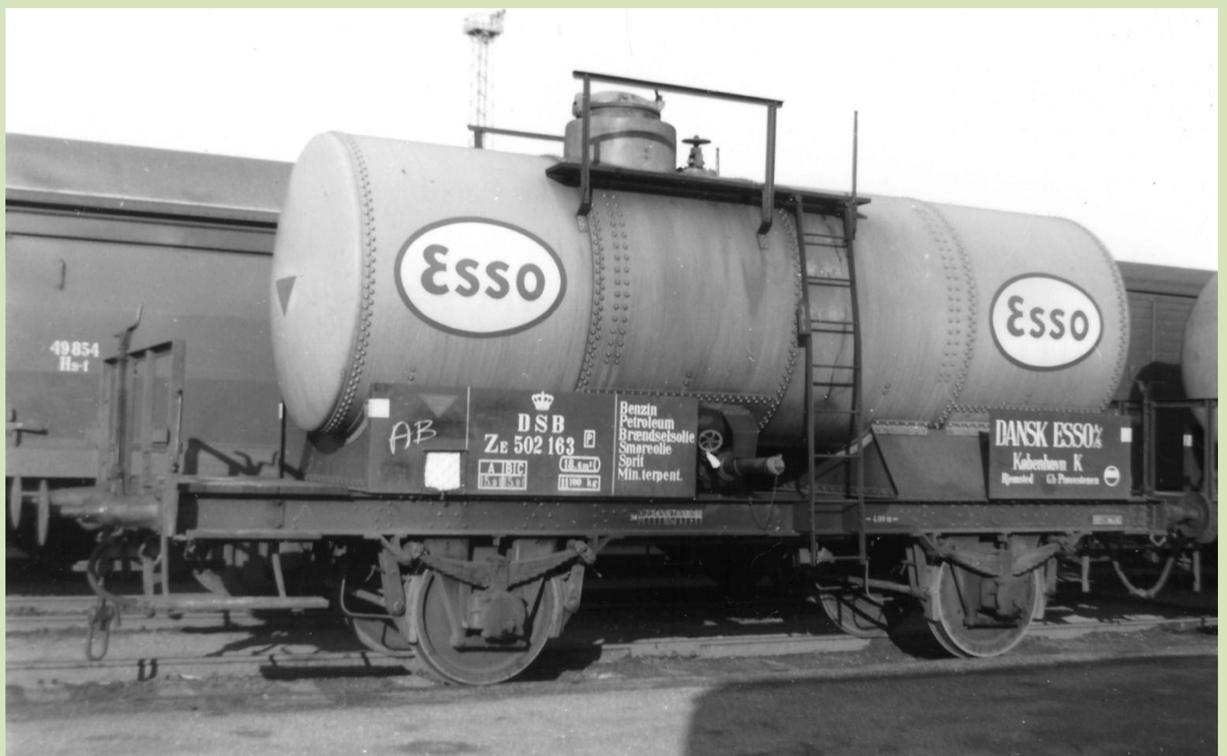
ZE 502 163. i 1964. vognene har nu fået flyttet alle påskrifter (undtagen logo) ned på 2 påskriftplader, bærekonsoller til tanken er nu sort som undervognen og bremsehus er fjernet. Foto.: C. Oddershede.
